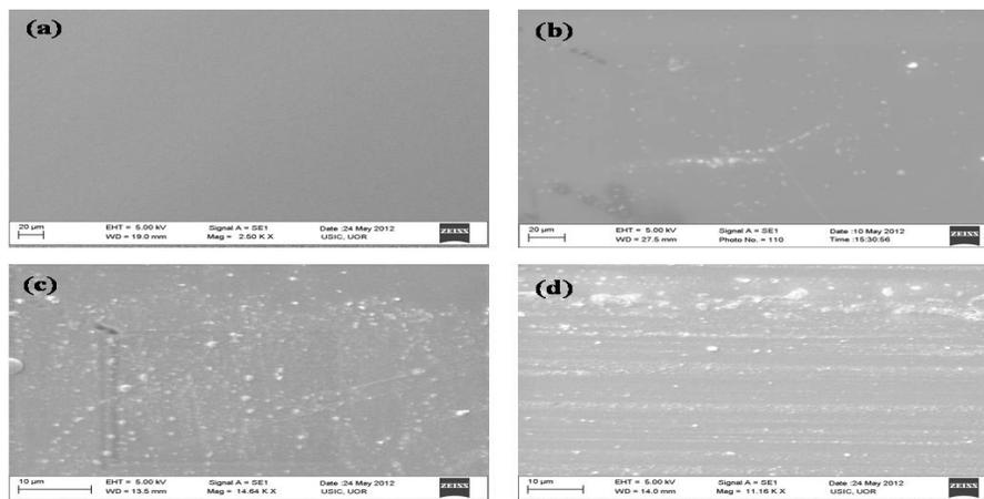
Fig. 4. SEM micrographs of polycarbonate film (a) untreated, (b) 10 min, (c) 30 min and (d) 60 min.
