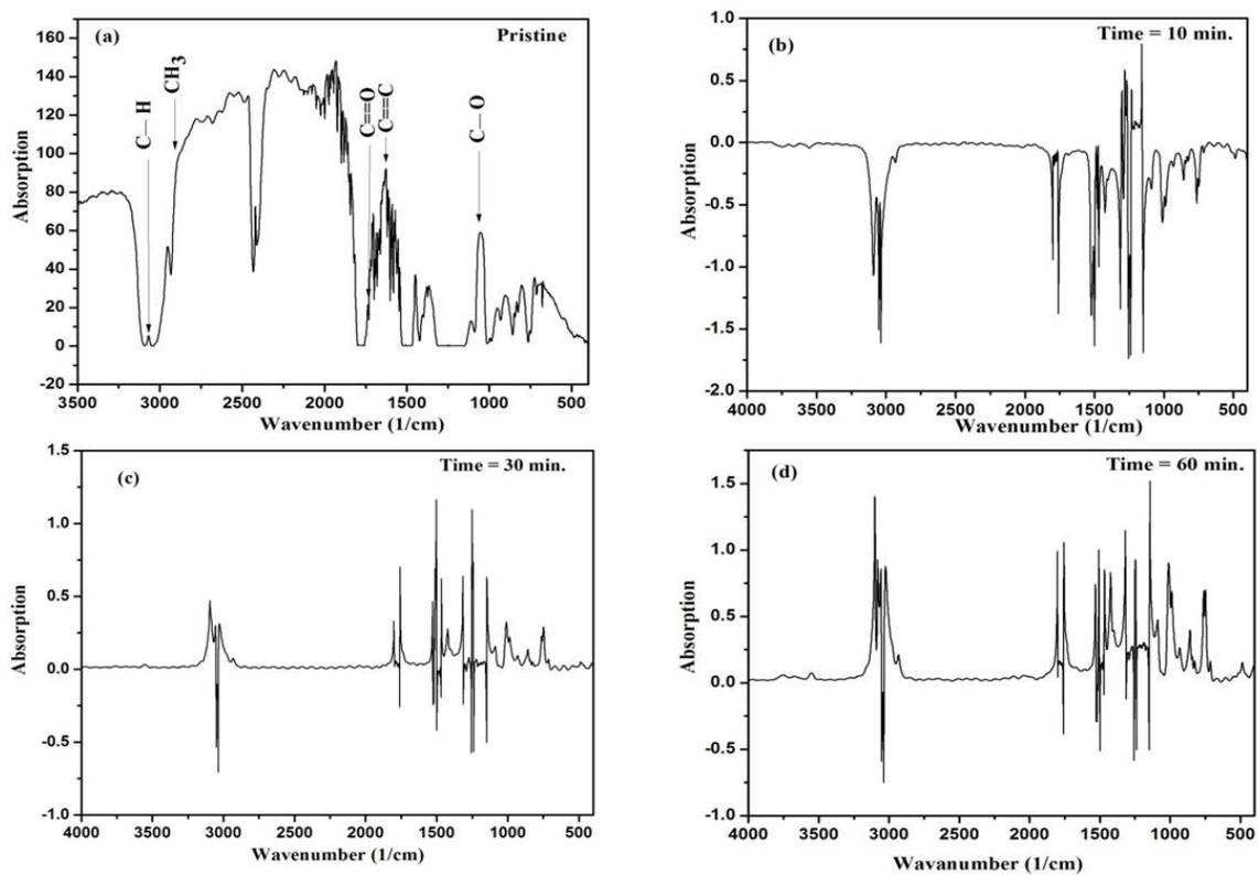
Fig. 6. FTIR spectrum for polycarbonate film (a) untreated, (b) 10 min, (c) 30 min and (d) 60 min.
